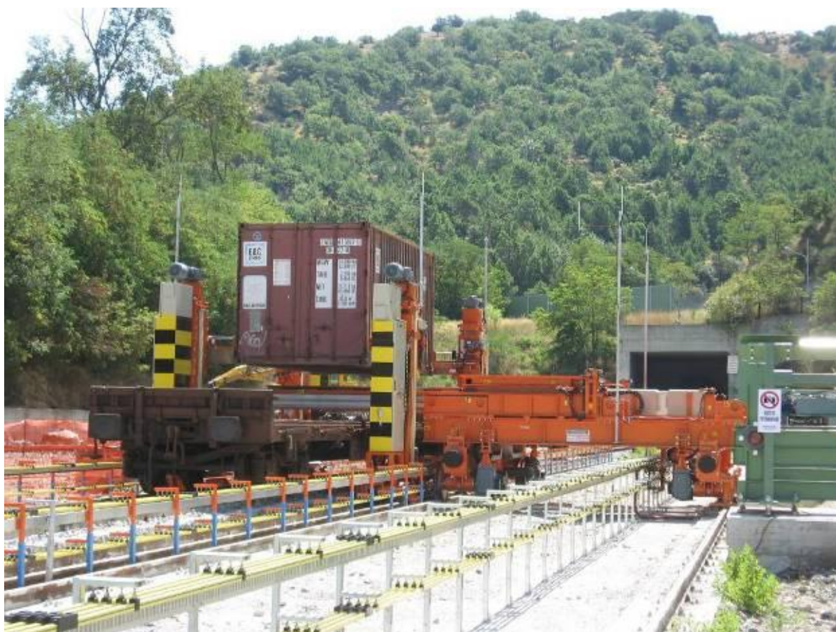
Attrezzatura di carico/scarico a traslazione orizzontale Metrocargo in funzione presso il terminal di Vado Ligure (SV)
